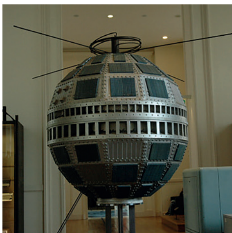
Le satellite de télécommunications "Telstar 1" (1960), satellite de relais des programmes de télévision entre les États-Unis et l'Europe.
