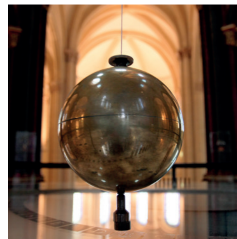
Le pendule de Foucault (1851), dispositif permettant de mettre en évidence la rotation de la Terre sur elle-même.
